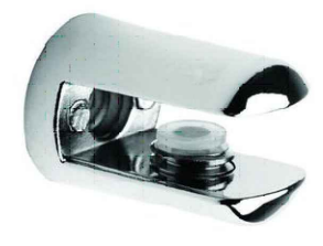
Support tablette cylindrique Ø 20 mm x long. 24 mm. Pour ép. 11 mm maxi, Ø du clou de fixation : 5 mm, en zamak chromé Référence PER081 chez BERTHET
