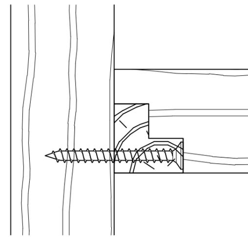
Fixation étagère invisible sur aménagement séjour - Détail 11 (Usinage arété, invisible de face)
